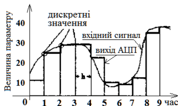
Рисунок 1 – Дискретизація і екстраполяція нульового порядку аналогового сигналу
